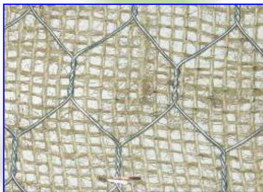
Foto 7 – R.E.C.S.™ Standard con agave 700 gr/mq
